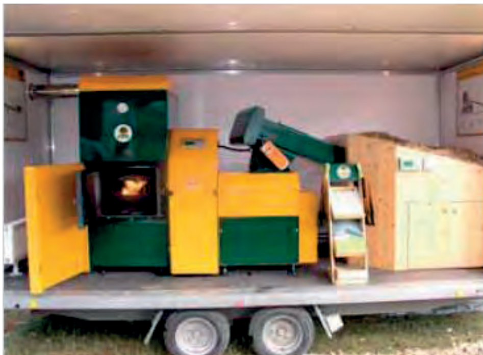
Automatický kotel na štěpku s automatickým provozem
