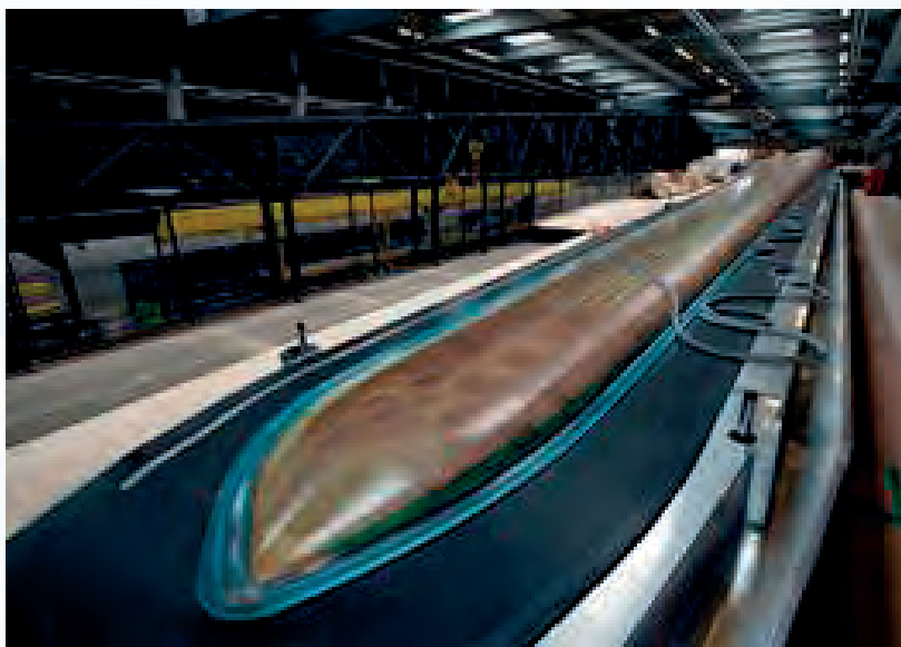
Obr. 2.30 Pohled do formy, kde jsou k sobě již slepeny poloviny listu. Je zde pěkně vidět, že se jedná o sendvičovou konstrukci listu. Hnědá pole jsou jednotlivé kousky tvrzené pěny. Zdroj: http://www.csve.cz .
