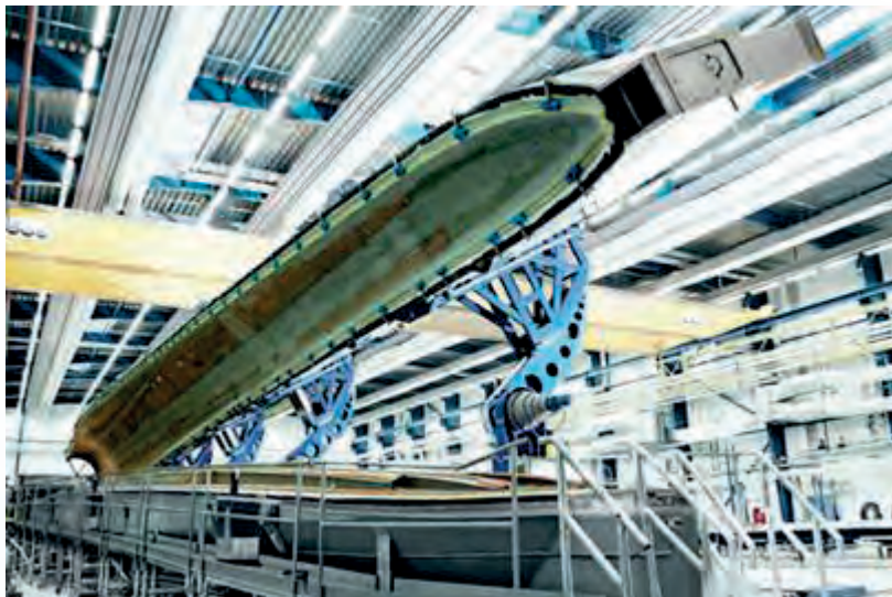
Obr. 2.29 Přiklopení horní formy horní poloviny listu na spodní. Zdroj: http://www.csve.cz
