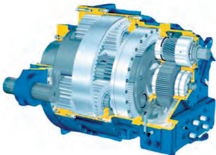
Obr.2.42 Převodovka větrné elektrárny od firmy Bosch-Rexroth s označením Redulus GPV pro výkon 2MW. Jedná se o dvoustupňovou planetovou převodovku s výstupním koaxiálním stupněm. Zdroj: http://www.csve.cz .
