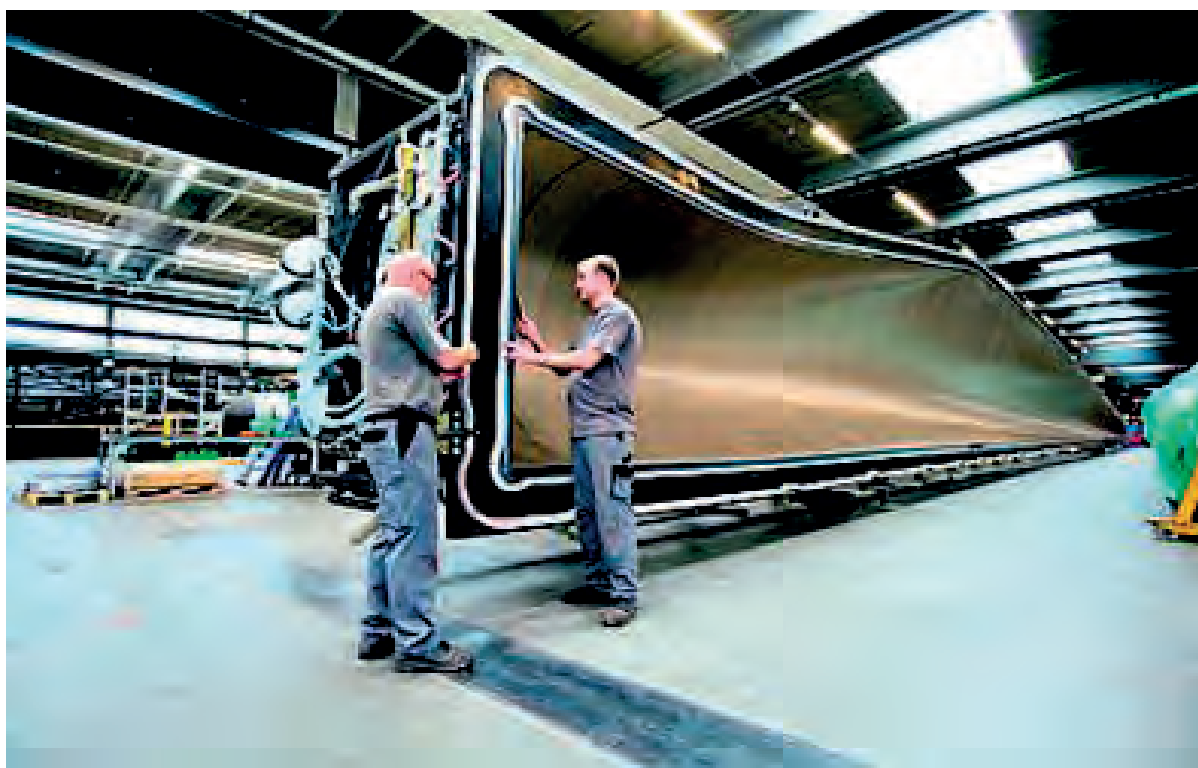
Obr. 2.24 Negativní forma pro laminování rotorového listu. Na fotografii je vidět včetně nosného rámu a technologii pro vakuování. Zdroj: http://www.csve.cz .
