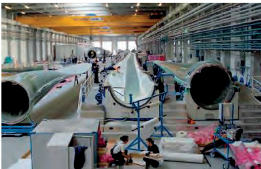
Obr. 2.27 Pohled do haly laminování rotorových listů. Uprostřed je vidět forma s vylaminovanou polovinou listu. Po stranách pak již slepené listy ze dvou polovin. Zdroj: http://www.csve.cz .
