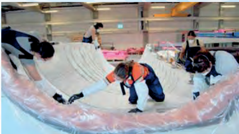
Obr. 2.26 Výroba rotorového listu ve firmě Enercon. Je pěkně vidět, jak musí být tkanina rozdělena na mnoho dílů, aby se mohla vložit do tvarově náročné formy. Zdroj: http://www.csve.cz .
