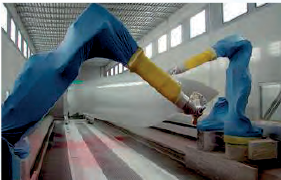
Obr. 2.32 Rotorový list se musí ještě povrchově upravit, např. robotickou linkou. Zdroj: http://www.csve.cz .
