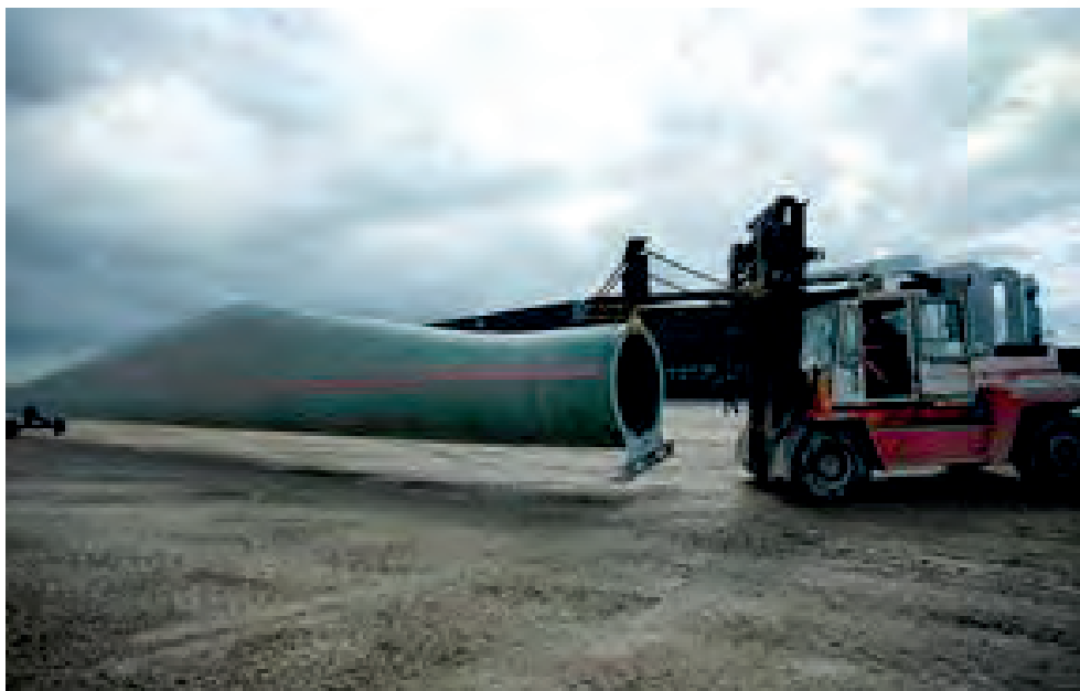
Obr. 2.31 Manipulace s rozměrnými rotorovými listy je velmi specifická. Zdroj: http://www.csve.cz .
