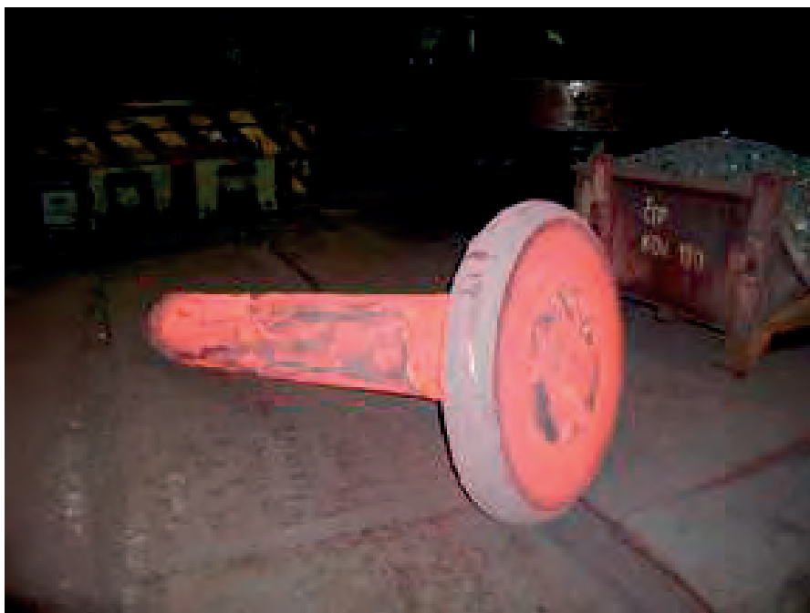
Obr.2.40 Budoucí hlavní hřídel větrné elektrárny. Zde ještě jako polotovár – výkovek. Zdroj: http://www.csve.cz .
