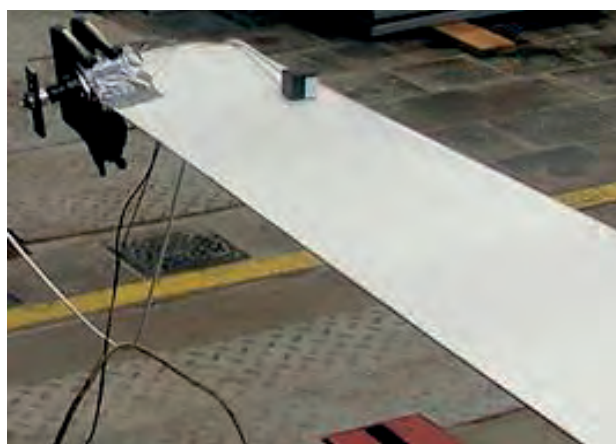
Obr.2.36 Detail budiče kmitů a snímače frekvencí. Zdroj: http://www.csve.cz .
